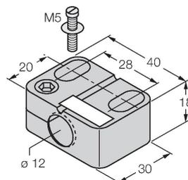
Befestigungsschelle für Gewinderohrsensoren, mit Festanschlag; Werkstoff: PA6
