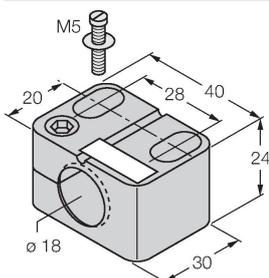
Befestigungsschelle für Gewinderohrsensoren, mit Festanschlag; Werkstoff: PA6
