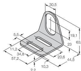
Befestigungswinkel für Gewinderohrsensoren; Werkstoff: Edelstahl A2 1.4301 (AISI 304)
