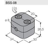
Befestigungsschelle für Glatt -und Gewinderohrsensoren; Werkstoff: Polypropylen
