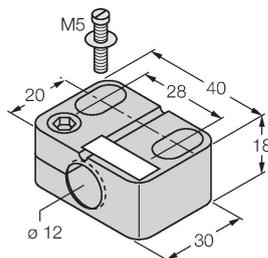
Befestigungsschelle für Gewinderohrsensoren, mit Festanschlag; Werkstoff: PA6
