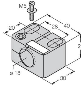
Befestigungsschelle für Gewinderohrsensoren, mit Festanschlag; Werkstoff: PA6
