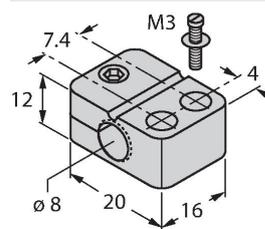
Befestigungsschelle für Gewinderohrsensoren, mit Festanschlag; Werkstoff: PA6
