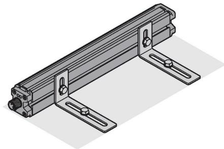
Umfangreiches Montagezubehör ermöglicht vielfältige Einbaumöglichkeiten. Bedingt durch das Messprinzip, das auf einer Schwingkopplung basiert, ist der Linearwegsensor unempfindlich gegenüber aufmagnetisierten Eisenteilen oder sonstigen Störfeldern.
