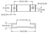
Montagefuß für Linearwegsensoren LI-Q25L; Material Aluminium; 2 Stück pro Beutel
