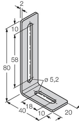
Montagewinkel und Nutstein für Linearwegsensoren LI-Q25L; Material: Edelstahl; 2 Stück pro Beutel
