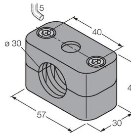
Befestigungsschelle für Glatt- und Gewinderohrsensoren; Werkstoff: Polypropylen
