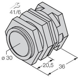
Schnellmontagehalterung mit Festanschlag; Werkstoff: Messing verchromt. Außengewinde M36 x 1,5. Hinweis: Der Schaltabstand der Näherungsschalter kann sich durch Verwendung von Schnellmontagehalterungen ändern.
