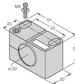
Befestigungsschelle für Gewinderohrsensoren, mit Festanschlag; Werkstoff: PA6
