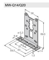
6945006 Befestigungswinkel für Quaderbauform Q14 oder Q20; Werkstoff VA 1.4301
