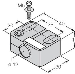
Befestigungsschelle für Gewinderohrsensoren, mit Festanschlag; Werkstoff: PA6
