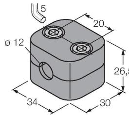
Befestigungsschelle für Glatt- und Gewinderohrsensoren; Werkstoff: Polypropylen
