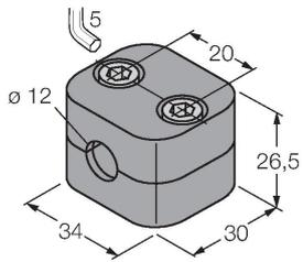
Befestigungsschelle für Glatt - und Gewinderohrsensoren; Werkstoff: Polypropylen
