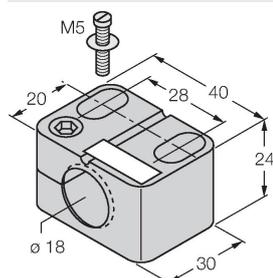
Befestigungsschelle für Gewinderohrsensoren, mit Festanschlag; Werkstoff: PA6
