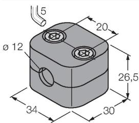
Befestigungsschelle für Glatt- und Gewinderohrsensoren; Werkstoff: Polypropylen
