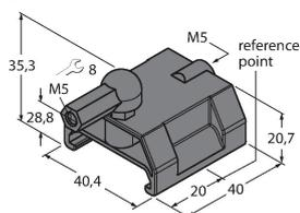
Geführter Positionsgeber für Linearwegsensoren LI-Q25L, wird in die Nut des Sensors geführt
