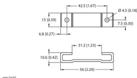
Montagefuß für Linearwegsensoren LI-Q25L; Material Aluminium; 2 Stück pro Beutel
