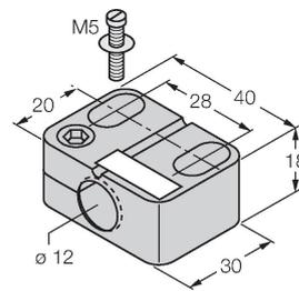
Befestigungsschelle für Gewinderohrsensoren, mit Festanschlag; Werkstoff: PA6
