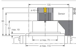
Aufbauset für Doppelsensoren für größere Schwenkantriebe; Ø Scheibe und Sprengring: max. 110 mm; Lochbild auf Flanschfläche: 30 x 130 mm; Anschlusswelle (Wellenzapfen) Höhe: 50 mm / Ø: max. 75 mm
