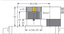
Aufbauset für Doppelsensoren für größere Schwenkantriebe; Ø Scheibe und Sprengring: max. 65 mm; Lochbild auf Flanschfläche: 30 x 80 mm (30 x 130 mm); Anschlusswelle (Wellenzapfen) Höhe: 20 mm (30 mm) / Ø: max. 40 mm
