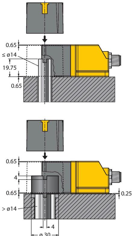
Ri-DSU35 für die Montage auf Schwenkantrieben
