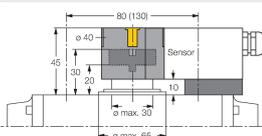
Aufbauset für Doppelsensoren für größere Schwenkantriebe; Ø Scheibe und Sprengring: max. 65 mm; Lochbild auf Flanschfläche: 30 x 80 mm (30 x 130 mm); Anschlusswelle (Wellenzapfen) Höhe: 20 mm / Ø: max. 30 mm
