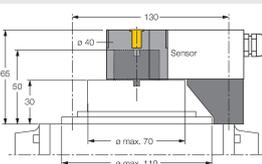
Aufbauset für Doppelsensoren für größere Schwenkantriebe; Ø Scheibe und Sprengring: max. 110 mm; Lochbild auf Flanschfläche: 30 x 130 mm; Anschlusswelle (Wellenzapfen) Höhe: 30 mm / Ø: max. 70 mm
