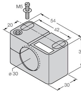
Befestigungsschelle für Gewinderohrsensoren, mit Festanschlag; Werkstoff: PA6
