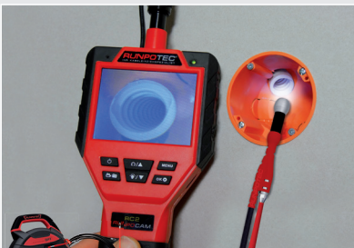
Rohr-inspektion ab \varnothing 14 mm und mehr
