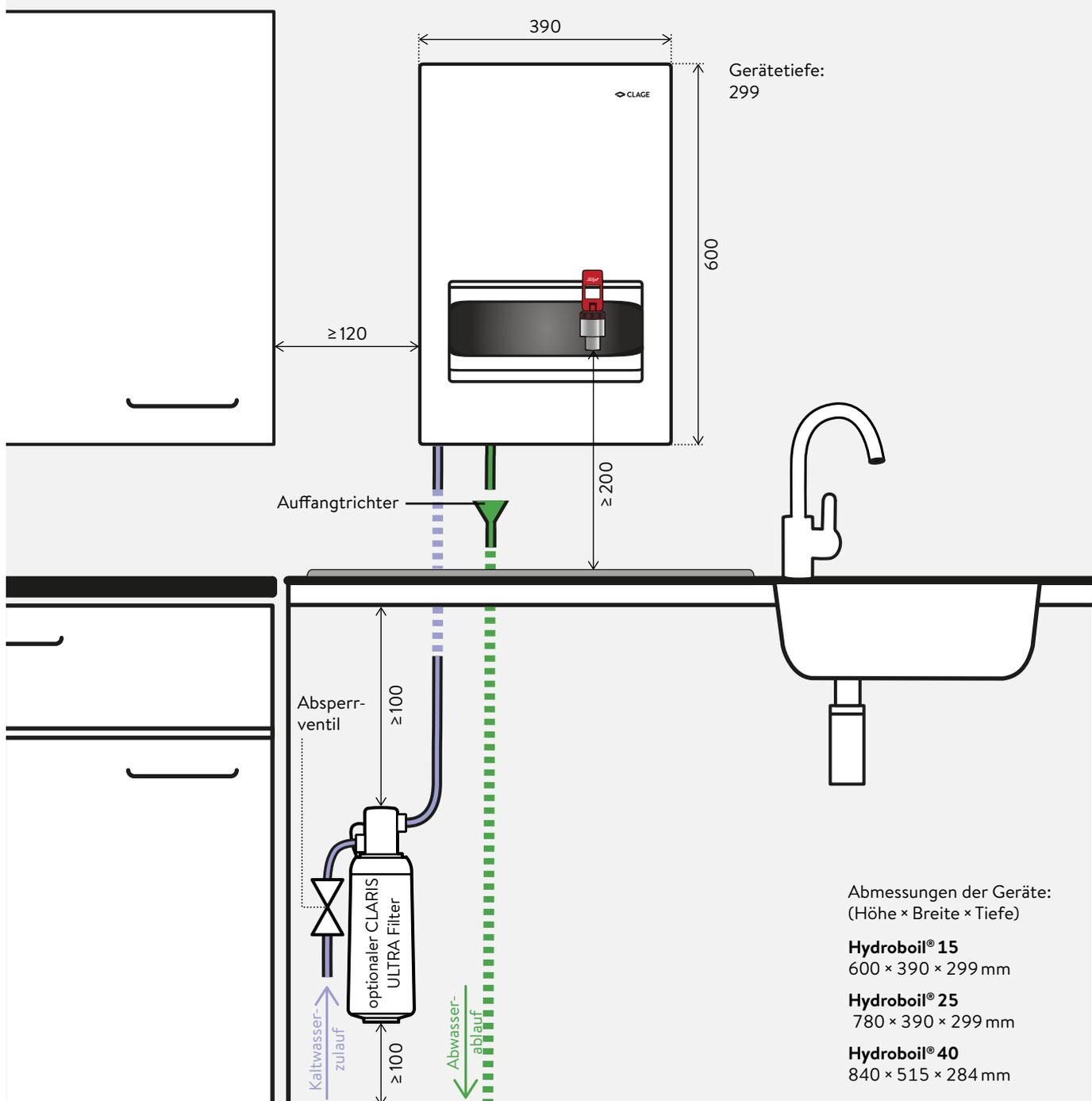
Das Beispiel zeigt die Wasseranschlüsse bei der Installation eines Hydroboil®15, als Aufputzinstallation mit sichtbarem Auffangtrichter.
