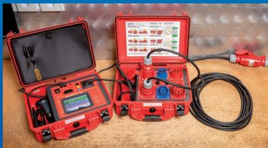
Prüfung einer 5-poligen CEE-Verlängerung
