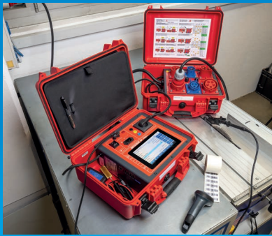
Aktive Prüfung einer 3-phasigen Tischkreissäge
