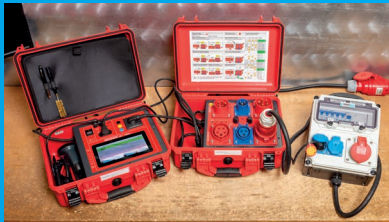
Prüfung einer mobilen Stromverteilung mit RCD
