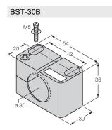
6947216 Befestigungsschelle für Gewinderohrsensoren, mit Festanschlag; Werkstoff: PA6
