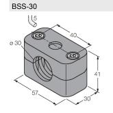
Befestigungsschelle für Glatt -und Gewinderohrsensoren; Werkstoff: Polypropylen
