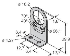
Montagewinkel, verzinkter Stahl, für Bauform LX, Kit bestehend aus 2 Stück, nicht im Lieferumfang des Sensors enthalten
