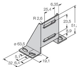
Standfuss, verzinkter Stahl, für Bauform LX
