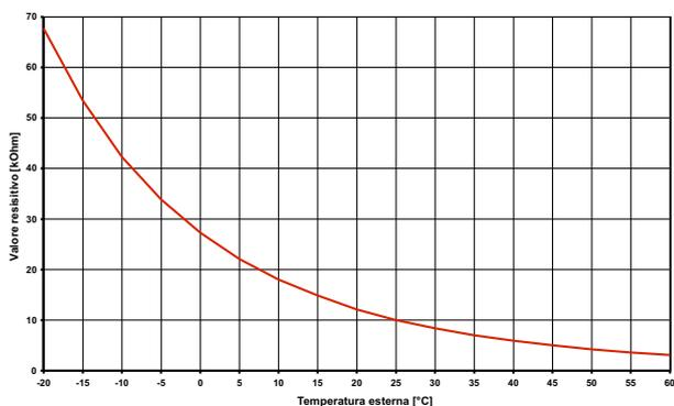
Fig. 7.2: Curva caratteristica della sonda NTC 10
