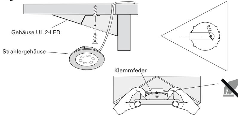
Schutzfolie vom Gehäuse des UL 2-LED entfernen! Gehäuse des UL 2-LED in die gewünschte Position bringen. Gehäuse mit der Schraube durch die Laschenbohrung befestigen. Den LED-Strahler in den vorgesehenen Ausschnitt mit den Klemmfedern parallel zur Wand einsetzen und eindrücken.
