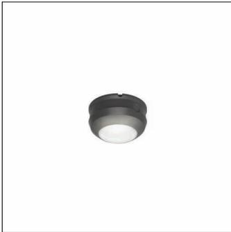
SITECO Connect WirelessMotion High, Smart Interface unten, Einstellung des EVG's auf logarithmische DALI Dimmung erforderlich, Montageart: Schraubbefestigung, Montageort: an der Leuchte, aus Kunststoff, Spannung: 24V, Spannungsart: DC, Bluetooth, D4i, Lokale Einstellung und -Bedienung mit Smartphone-App, nach Tageslicht, nach Bewegung, 1 PIR Bewegungssensor, Tageslichtsensor, PIR-Bewegungssensor, Schutzart (gesamt): IP66, Prüfzeichen: CE, UKCA, Verpackungseinheit: 1 Stück
