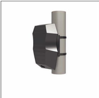
SITECO Connect Wireless Mast Box Motion Low, Montageart: Anbau, Montageort: am Mast, aus Kunststoff, Spannung: 230V, Spannungsart: AC, 2,4GHz, Lokales Maschen-Funknetzwerk, DALI, Lokale Einstellung und -Bedienung mit USB-Stick, nach Bewegung, optional per Funk-Taster, 1 PIR Bewegungssensor, Funk, 2,4GHz, Schutzart (gesamt): IP65, Prüfzeichen: CE, Verpackungseinheit: 1 Stück
