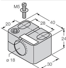
Befestigungsschelle für Gewinderohrsensoren, mit Festanschlag; Werkstoff: PA6
