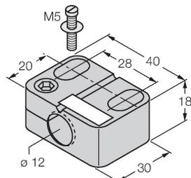
Befestigungsschelle für Gewinderohrsensoren, mit Festanschlag; Werkstoff: PA6
