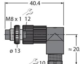
Konfektionierbarer Stecker, M8 x 1, gewinkelt, 4-polig, Eindringtechnik, Leitungsdurchlass 4.0 bis 5.0 mm, Adernquerschnitt/ Klemmvermögen 0.14 bis 0.34 mm<sup>2</sup>, Kunststoffgehäuse, Metallüberwurfmutter
