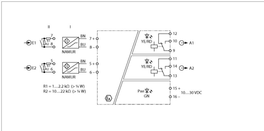
An den Trennschaltverstärker IMX12-DI01-2S-2R-0/24VDC/CC können Sensoren nach EN 60947-5-6 (NAMUR) oder potenzialfreie Kontakte angeschlossen werden. Das Gerät ist mit eigensicheren Eingangskreisen ausgestattet und kann in Zone 2 montiert werden. Das Gerät lässt sich über DIP-Schalter umschalten zwischen 2-kanaligem Betrieb oder 1-kanaligem Betrieb mit Signalverdopplung. Die Ausgangskreise sind mit zwei Wechsler-Relais ausgestattet. Das Gerät erfüllt die Anforderungen der NE21.
