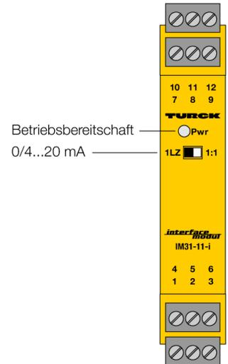
Über den 1-kanaligen Analogsignaltrenner IM31-11-I werden normierte, aktive Spannungs- oder Stromsignale galvanisch getrennt übertragen.
