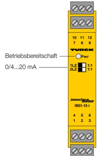
Über den 1-kanaligen Analogsignaltrenner IM31-12-I werden normierte, aktive Spannungs- oder Stromsignale galvanisch getrennt übertragen. Das Signal wird dupliziert und steht dadurch an beiden Ausgängen zur Verfügung.
