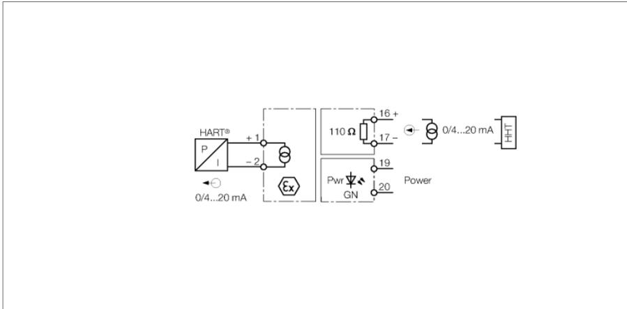
Über den 1-kanaligen Signaltrenner IM35-11EX-HI wird das normierte Stromsignal galvanisch getrennt aus dem Nicht-Ex-Bereich in den Ex-Bereich ohne Beeinflussung 1:1 übertragen. Neben dem Analogsignal können bidirektional auch die digitalen Signale der HART®-Kommunikation übertragen werden.
