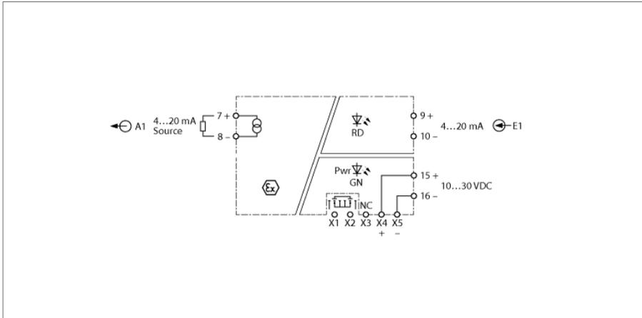
Über den 1-kanaligen Signaltrenner IMX12-AO01-1I-1I-HPR/24VDC wird das normierte Stromsignal 1:1 galvanisch getrennt aus dem Nicht-Ex-Bereich in den Ex-Bereich übertragen. Neben dem Analogsignal können bidirektional auch digitale Signale der HART®-Kommunikation übertragen werden. Typische Anwendungen sind die Ansteuerung von I/P-Wandlern oder Anzeigegegeräten im Ex-Bereich.
