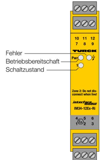
Mit dem 1-kanaligen Ex-Temperatur-Messverstärker des Typs IM34-12EX-RI werden die temperaturabhängigen Änderungen von Ni100/Pt100-Widerständen, Thermoelementen der Typen B, E, J, K, L, N, R, S und T oder Kleinspannungen im Bereich von -100...+160 mV ausgewertet und als Stromsignale von 0/4...20 mA temperaturlinear ausgegeben.
