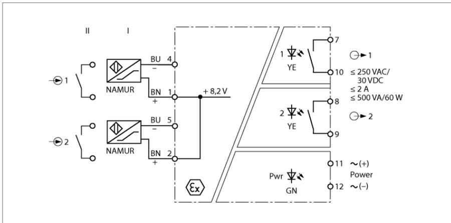
Der 2-kanalige Trennschaltverstärker vom Typ IM12-22EX-R/24VDC ist mit eigensicheren Eingangskreisen ausgestattet.
