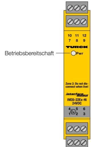
Über den 2-kanaligen Signaltrenner IM35-22EX-HI/24VDC wird das normierte Stromsignal galvanisch getrennt aus dem Nicht-Ex-Bereich in den Ex-Bereich ohne Beeinflussung 1:1 übertragen. Neben dem Analogsignal können bidirektional auch die digitalen Signale der HART®-Kommunikation übertragen werden.
