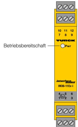
Über den 1-kanaligen Potentiometerverstärker IM36-11EX-I/24VDC werden Signale von Potenziometern in 3/5-Leiter-Schaltung galvanisch getrennt aus dem Ex-Bereich in den Nicht-Ex-Bereich übertragen und in normierte Analogsignale von 0...20 mA umgewandelt. Der Widerstandswert des Schleiferabgriffes wird von 0 Ω bis zum Nennwiderstandswert (Endwert) des Potenziometers erfasst und linear verarbeitet.
