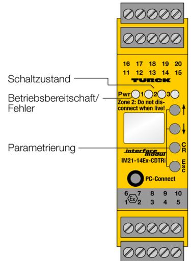
Mit dem Drehzahlwächter IM21-14EX-CDTRI werden Frequenzen, Drehzahlen und Impulsfolgen, beispielsweise von rotierenden Teilen an Motoren, Getrieben und Turbinen, ausgewertet und auf Über- bzw. Unterschreitung eingestellter Grenzwerte überwacht. Ein Display in der Gerätefront zeigt den aktuellen Wert an.
