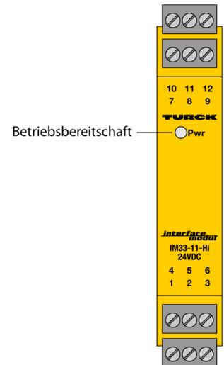
Über den 1-kanaligen HART<sup>®</sup>-Messumformer-Speisetrenner IM33-11-HI/24VDC werden HART<sup>®</sup>-2-Draht-Messumformer (III) betrieben und das Messsignal galvanisch getrennt übertragen. Neben den Analogsignalen können bidirektional auch die digitalen Signale der HART<sup>®</sup>-Kommunikation übertragen werden.
