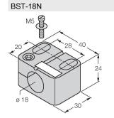
Befestigungsschelle für Gewinderohrsensoren, ohne Festanschlag; Werkstoff: PA6
