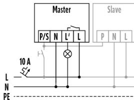
Standardbetrieb mit optionaler Ansteuerung durch Schließaster und Verwendung von max. 10 Slave-Geräten an einem Master-Gerät.
