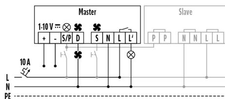
Standardbetrieb mit optionaler Ansteuerung durch Schließtaster und Verwendung von max. 10 Slave-Geräten an einem Master-Gerät.
