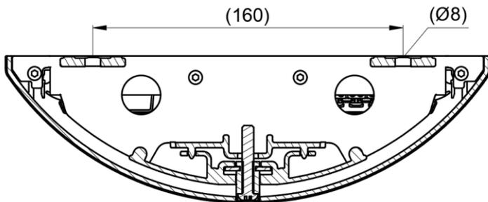
Zur Montage Schrauben  $\varnothing 6\text{mm}$  verwenden.
