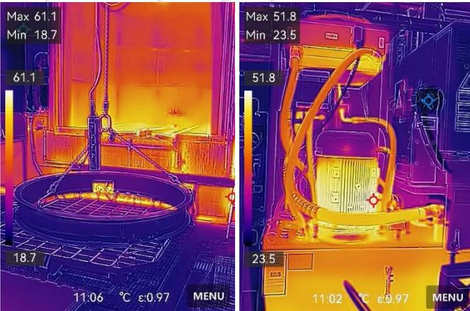
Die Industriethermografie wird im Maschinenbau zum Beispiel dafür eingesetzt, um Temperaturmessung an Getriebegehäusen, Lagern, Kompressoren, Hydraulik, Motoren, etc. durchzuführen.
