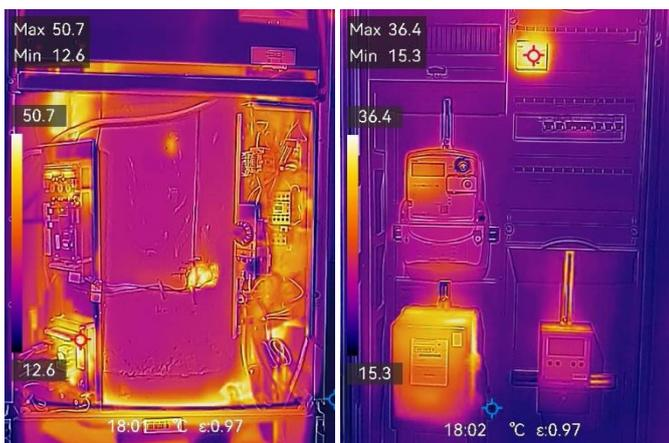
Die BENNING TC 30 macht Temperaturunterschiede auf den ersten Blick im Wärmebild deutlich sichtbar. Bei der thermischen Betrachtung zeigt sie ein strukturiertes Bild im 3,6" Farb-Touch-Display mit Temperaturangaben (Min. Max, CENTER), so dass eine Üblichkeitsabweichung erkannt wird.
