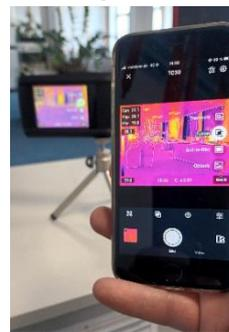
übliches Arbeitsmittel. Vorteil der thermografischen Messungen ist die Durchführung im laufenden Betrieb und aus sicherer Entfernung, um kritische elektrische und mechanische Bauteile, Anschlüsse oder Zonen zu prüfen. Die Entfernung zur Betrachtung lässt sich mit der Spiegelung des „BENNING TC 30 Bildes“ auf die iOS/Android-App noch erweitern und von dort direkt speichern und dokumentieren.
