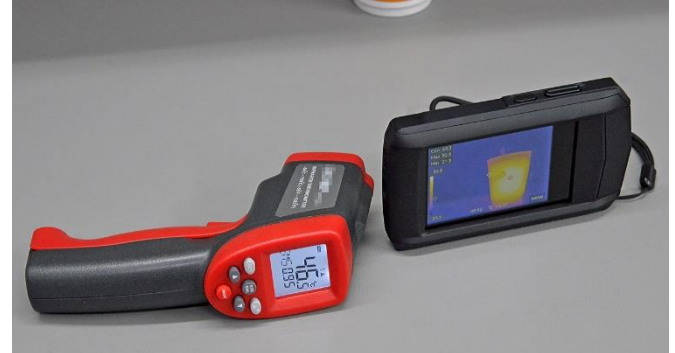
Größenvergleich: PIR-Thermometer gegenüber TC 30
