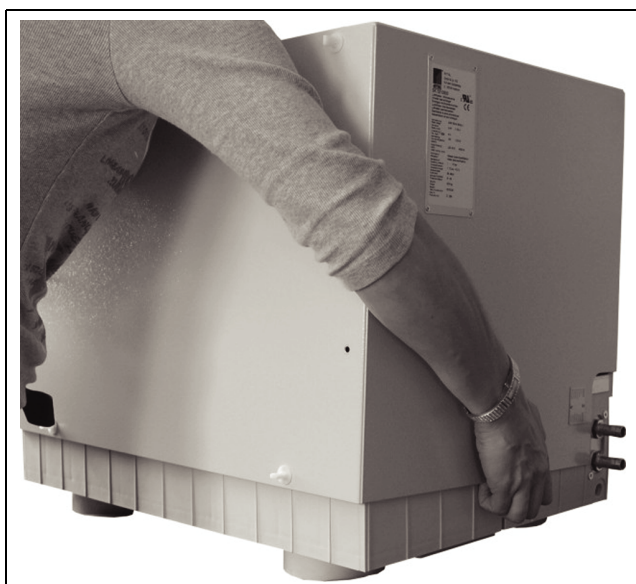
Fig. 28: Asportare la carteratura
