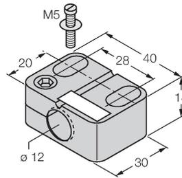
Befestigungsschelle für Gewinderohrsensoren, mit Festanschlag; Werkstoff: PA6
